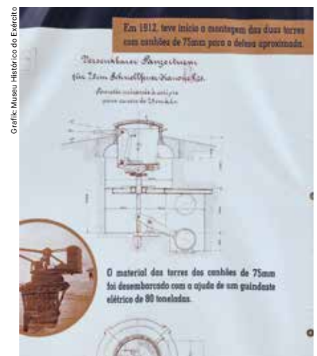
Der versenkbare Panzerturm mit 75-mm-Schnellfeuerkanone ist nur noch als technische Zeichnung zu besichtigen
