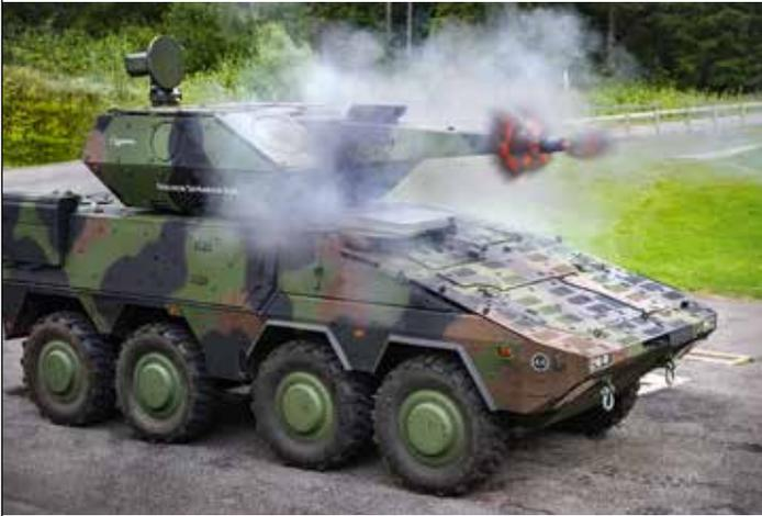
Der kommende Flugabwehrkanonenpanzer der Bundeswehr „Skyranger“ bei einer Vorführung des Herstellers Rheinmetall. Der „Skyranger“ soll vor allem Massen kleinerer Drohnen bekämpfen können.
