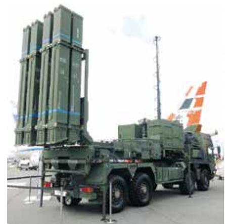
Der Starter des Flugabwehrraketensystems IRIS-T-SLM
